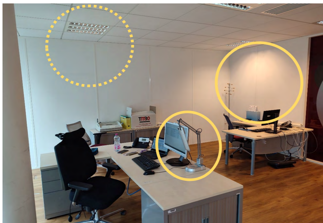
Utilisation d'une lampe d'appoint pour éviter l'éblouissement au-dessus du poste de travail
